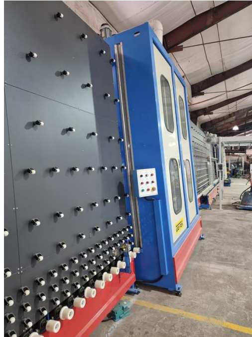
LÍNEA DE INSULADO
